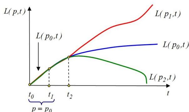
Рис. П4.1. Возможные траектории системы в точке бифуркации
